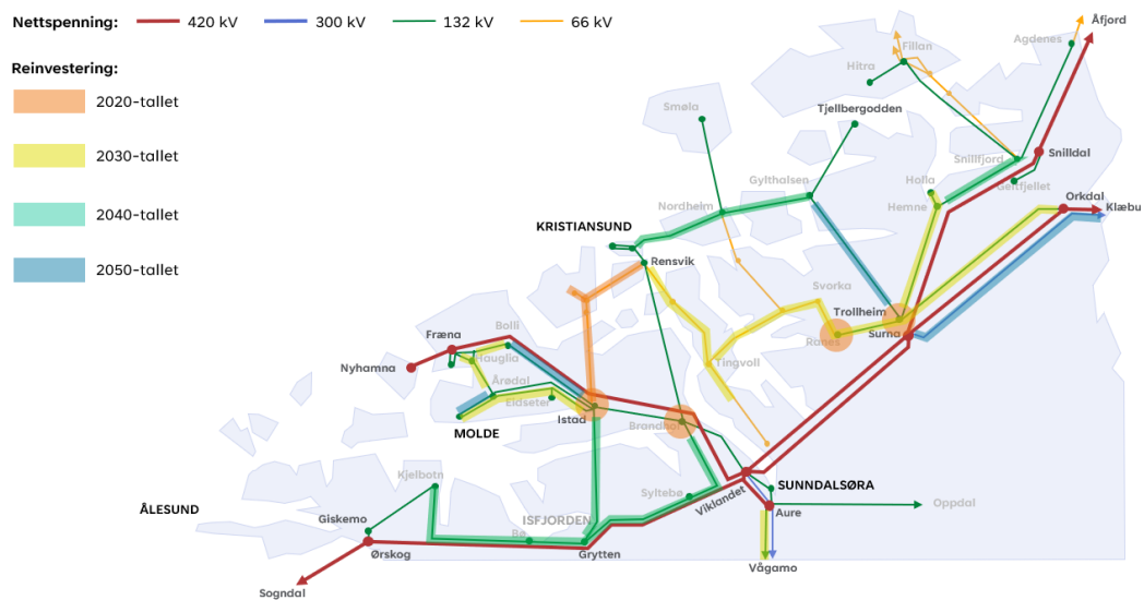
Figur 7-6 – Nødvendige reinvesteringer i transmisjons- og regionalnettet i Romsdal og Nordmøre frem mot 2050. Flere 66 kV-linjer til og ved kysten vil sannsynligvis erstattes med 132 kV linjer. Flere 132 kV linjer i indre strøk vil sannsynligvis saneres. Flere 300 kV linjer vil erstattes med 420 kV linjer. (Kilde: KVVU tilrettelegging for forbruksvekst Nordmøre og Romsdal (Statnett, 2022))
