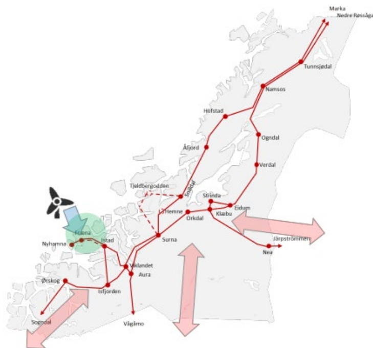
Figur 9-13 – Statnetts illustrasjon av målnett 2040 med mulige nye forbindelser i transmisjonsnettet, som ikke ennå er utredet, og Nyhamna/Fræna som gunstig tilknytningspunkt (grønn sirkel) (Statnett, 2023)
