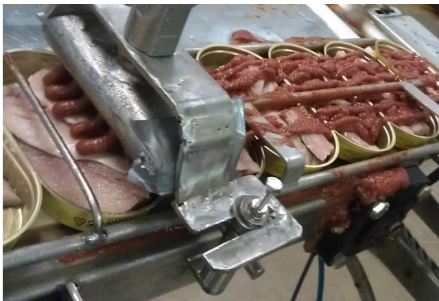
Figur 3. Fylling av tomatsaus i makrellboksene.
