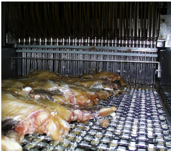
Bilde 3: Nåle-broen på Fomaco maskinen ved Olga Godø. Injisering av proteinhydrolysat i forsøk 3.
