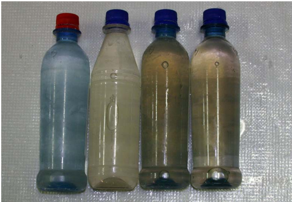
Figur 11. Lakeprøver fra venstre: Før bruk, etter vakuumbehandling (16 timer), etter 3 timers lakebad og etter 24 timers lakebad.
