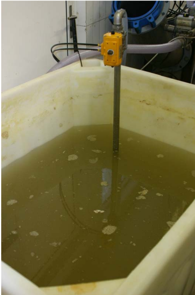
Figur 8. Lake etter endt syklus (16 timer) med vakuumbehandling.
