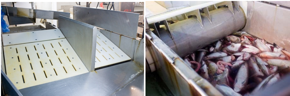
Figur 2. Blødekaret i fabrikk sett fra begge sider. De hvite platene som ses på bildet til venstre er vispene som kan dreies 360 grader, og brukes til deling og tømning av karet.
