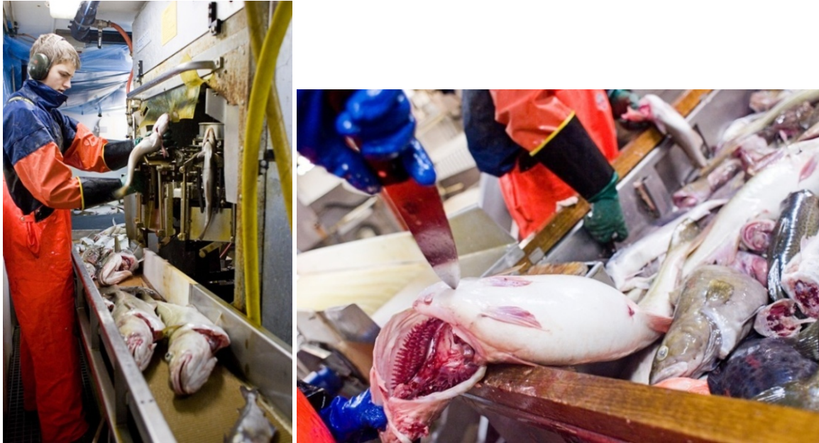
Figur 3. Maskinsløying av liten fisk (t.v.) og håndsløying av stor fisk
