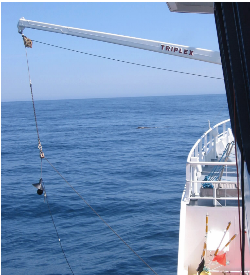
Figur 4 Bilde av transduseren og hvordan denne ble festet. I bakgrunnen kan ryggen og ryggfinnen på en spermhval sees i overflaten. (Foto: Arnstein Leinebø)
