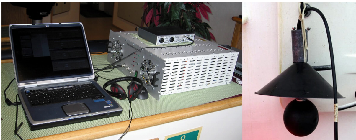
Figur 3 Bilder av ”scrambler” utstyret. Den bærbare pc-en er koblet til forsterkeren som igjen er koblet til den keramiske transduseren. Ovenfor transduseren er det påmontert en skjerm som skal lede lyden i en retning. (Foto: Arnstein Leinebø)
