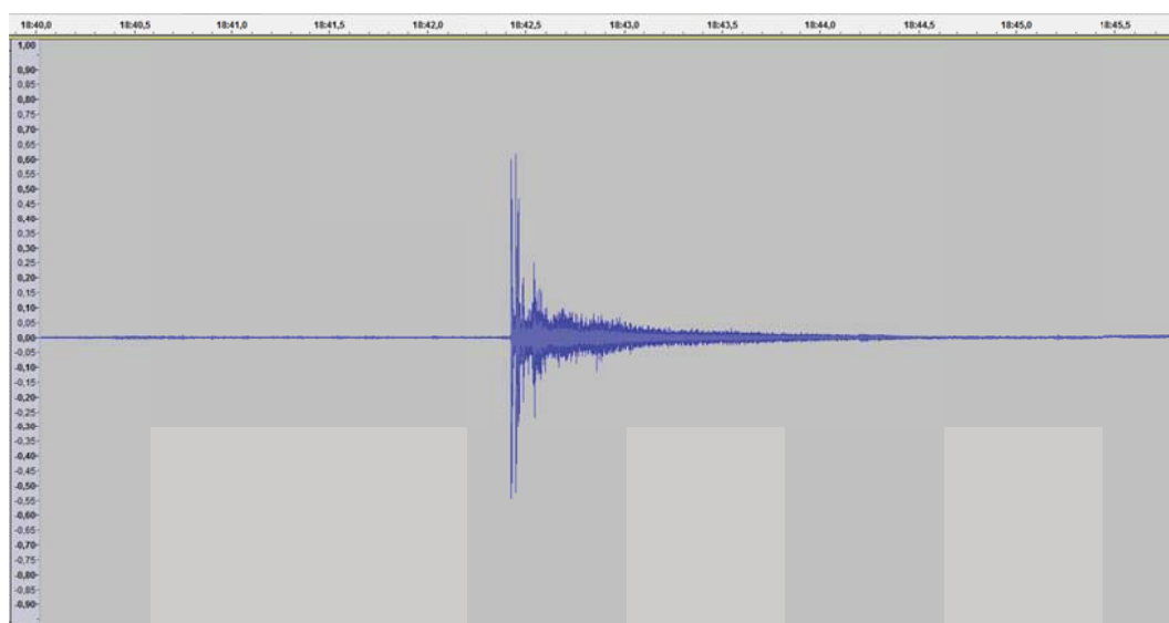
Figur 5 - Lydsignal fra seismisk kilde registrert umiddelbart etter fjerde avfiring.
