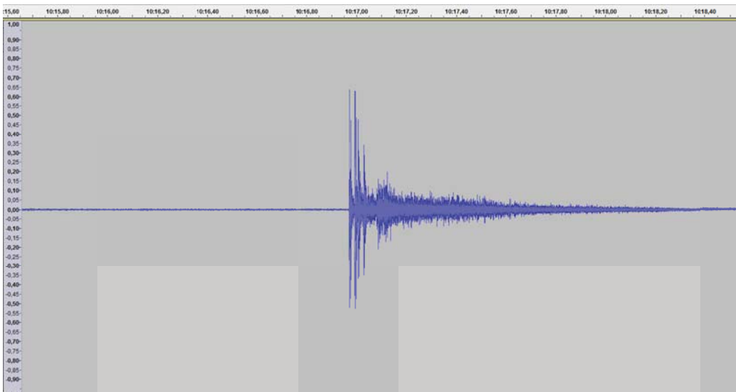
Figur 3 - Lydsignal fra seismisk kilde registrert umiddelbart etter andre avfyring.
